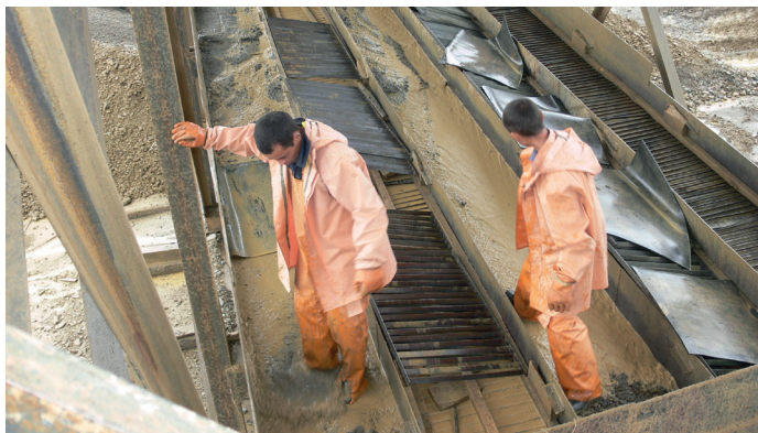
Сполоск платины на промприборе
